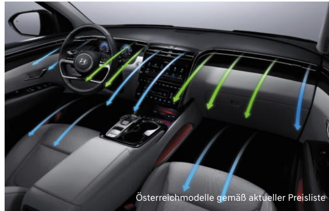
Multi-Air-Modus mit indirekten Lufteinlässen
